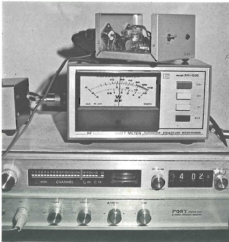
L'efficienza del lineare può essere controllata con un wattmetro per AF, ma un valido test è anche la prova in aria.
