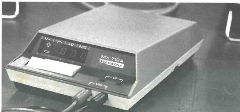
Un multimetro digitale: ottima impedenza d'ingresso ma prezzo molto elevato!
